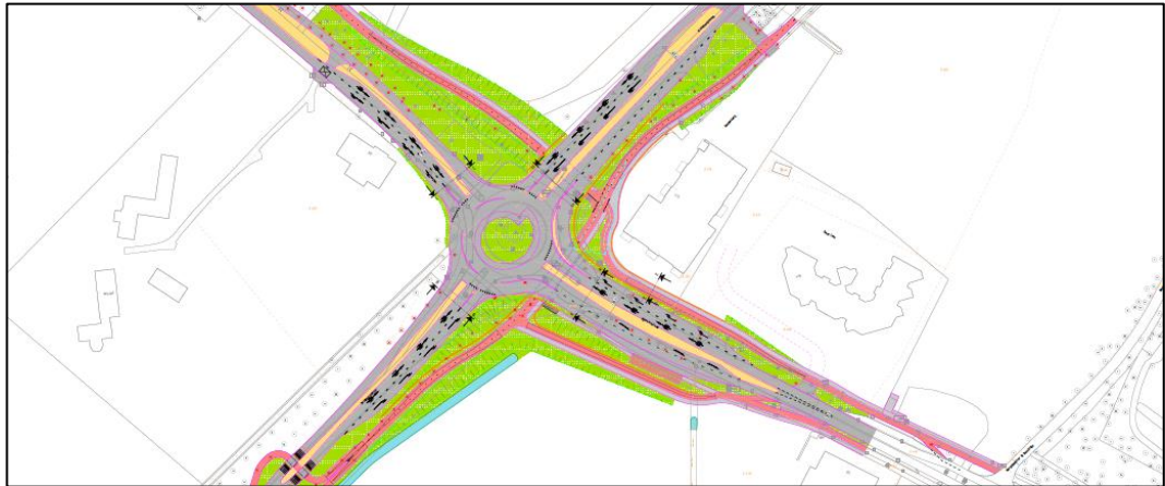
Afbeelding 1.2; oplossing turborotonde met fietstunnels
