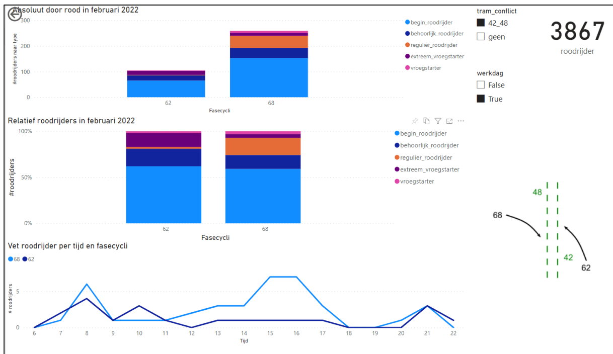
Voorbeeld van een analyse van roodlichtnegatie voor het kruispunt Laan van Maarschalkerweerd-tramdoorsteek (kruispunt 176).
