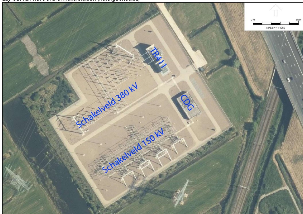
f2.2 Lay-out van het transformatorstation (huidige situatie)
