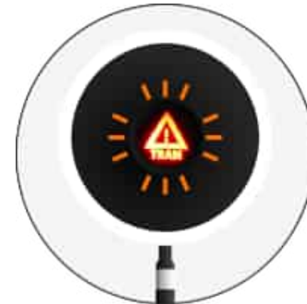
Figuur 6. De TWI zoals toegepast in de Provincie Utrecht. De TWI kenmerkt zich door een zwart-wit gemarkeerde paal met daarop een oranje waarschuwingslicht. Het licht heeft een driehoek met uitroepetekens en daaronder de tekst 'tram'.
