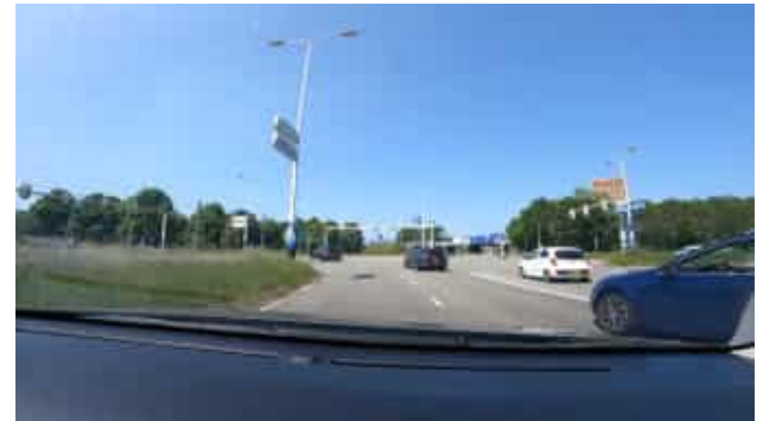
Figuur 5. Het ongemaaid gras aan linkerkant verhindert het zicht op de komende tram-wegkruising voor het afbuigende verkeer.
