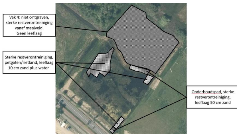
Figuur 7-5. Locaties waar saneringswerkzaamheden zijn uitgevoerd op de Duphar-locatie, de standplaats van geelschorpioenmos is niet ontgraven. Schriftelijke med. M. van der Valk.
