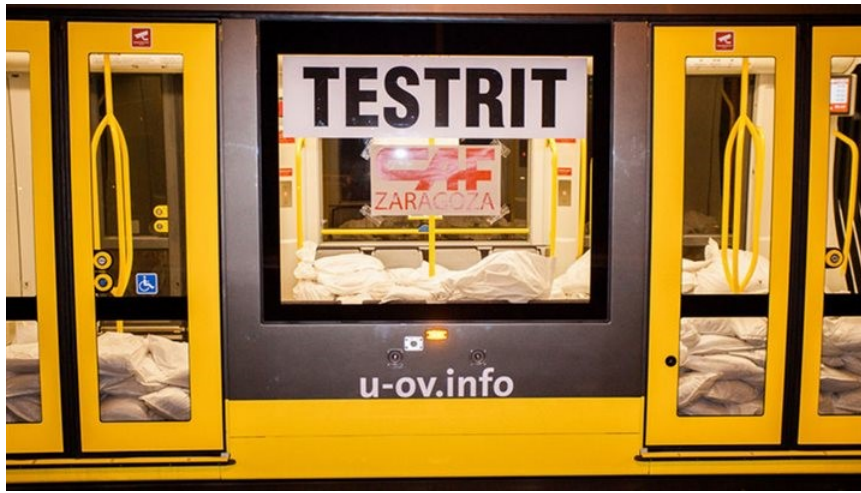
Testrit met zandzakken – als gewicht van reizigers
