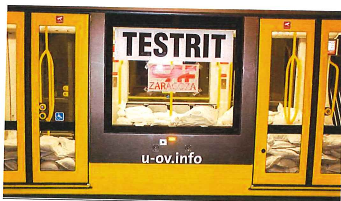
Testrit met zandzakken – als gewicht van reizigers
