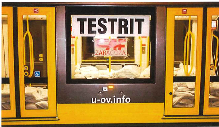
Testrit met zandzakken – als gewicht van reizigers
