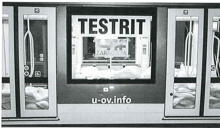
Testrit met zandzakken – als gewicht van reizigers
