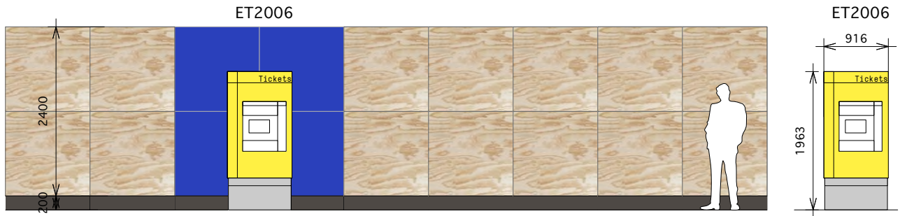
1. Eén kaartverkoopautomaat: plaats deze exact in het midden van het blauwe vlak.
