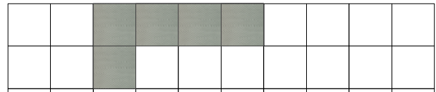
1X4 HAAKVORM , KAN OOK GESPIEGELD WORDEN TOEGEPAST, afhankelijk van de totale lengte van de wand.
